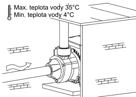
1. Pokuste se přívodní potrubí mít během instalace co nejkratší a s co nejmenším počtem ohybů. Udržujte čerpadlo na suchém a dobře větraném místě. V případě instalace ve venkovním prostředí zajistěte, že bude čerpadlo dostatečně chráněno proti vlivům počasí.
